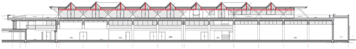
Coupe longitudinale - Modification des faux-plafonds
