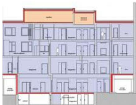
**Enveloppe étanche = un bon système de ventilation** pour garantir la qualité de l'air intérieur : une des cages d'ascenseurs est condamnée et utilisée pour le passage des conduites de ventilation.
