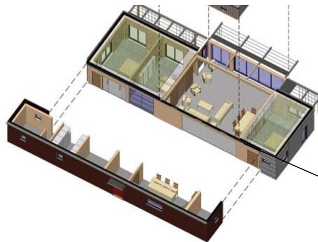
La maison peut facilement être agrandie : il suffit de retirer certains panneaux et d'étendre le concept. Cela permet également de limiter les déchets par rapports à une extension plus conventionnelle où le mur aurait été détruit.
